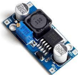
Fig. 5. XL6009 booster circuit module.
