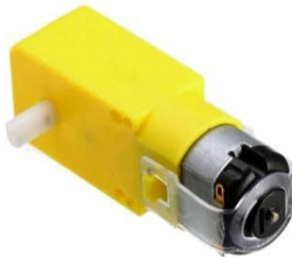
Fig. 7 : DC Gear Box Motor
