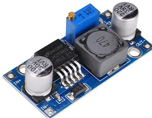
Fig. 6. DC DC buck convert
