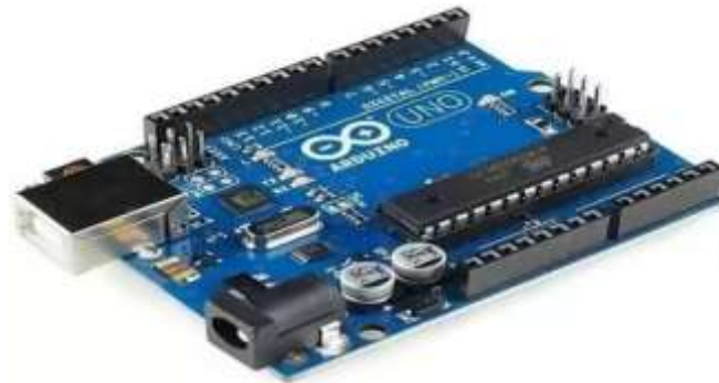
Fig (1). Arduino UNO
