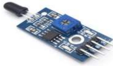
Fig (2). Flame Sensor
