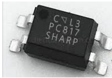
Fig.12. PC817 Optical Isolator IC
