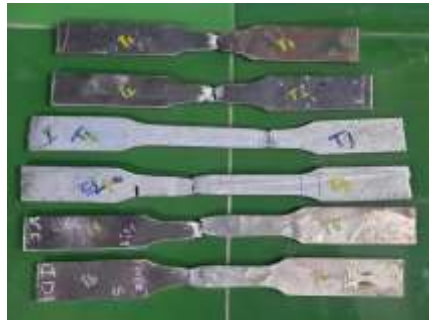
Fig 2 Trail 1 & 2 tensile results samples of (a) SA 266 GR.2 & SA 266 GR.2; (b) SS 316 & SS 316 (c) SA 266 GR.2 & SS 316
