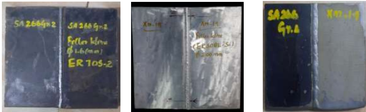
Fig. 1 – Welding of (a) SA 266 GR.2 & SA 266 GR.2 (b) SS 316 & SS 316 (c) SA 266 GR.2 & SS 316
