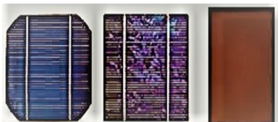
a) Mono crystalline b) Polycrystalline c) Amorphous silicon
