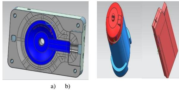
Fig. 6 a) Cavity insert b) core inserts
