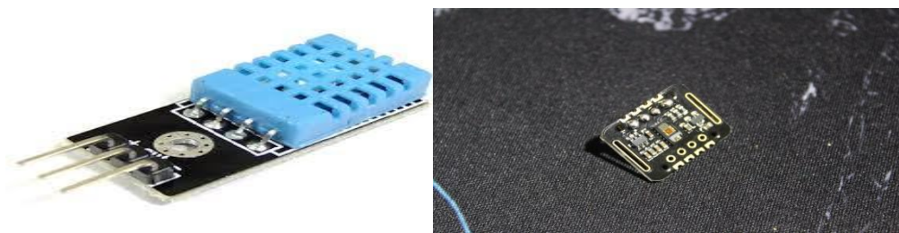
Fig. 3 DHT 11 & Pulse oximeter
