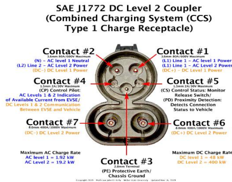
Fig: 4 SAE J1772 connector
